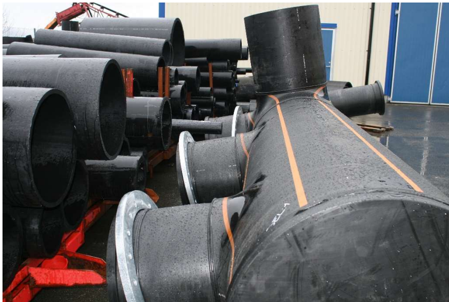
Figur 7: 1200 rør med uttrekk.
