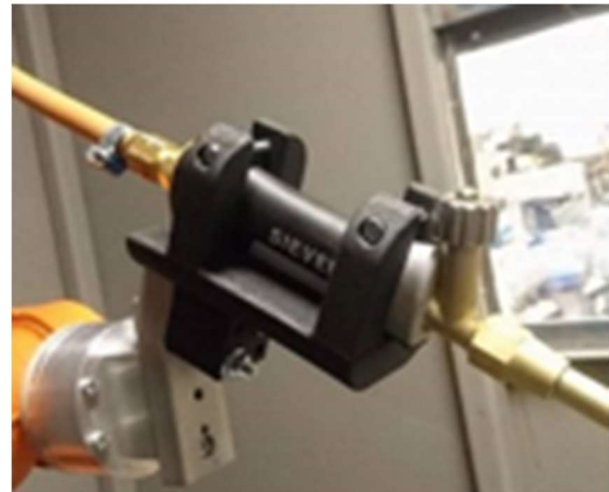
Figur 37: Holder til brenner3D-printet i HDPLA
